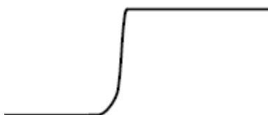
図 13: 短いグランド・リード使用時の信号
