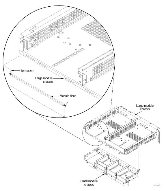
Figure 4-18: Module slot door removal
