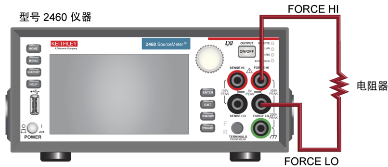
图 19：型号 2460 仪器 2 线前面板连接
