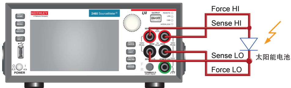
图 45：到 Model 2460 前面板的 4 线连接
